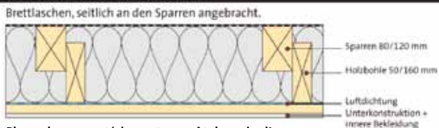
Plus-value en matériaux et en coût de main d'oeuvre en comparaison avec la Poutre en T, env. 20%
